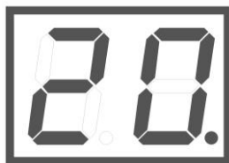
Рисунок 9 – Обороти вентилятора - потужність вентилятора в процентах
